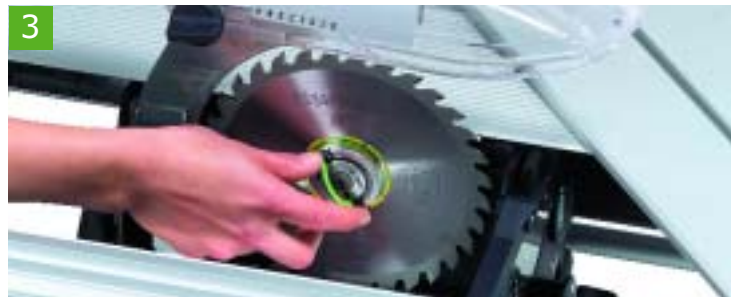
Uitklapbare draaigreep om de snelspanmoer los te draaien.
