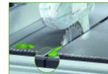
Skala's zijn instelbaar en kunnen worden ingesteld op de zaagbreedte.
