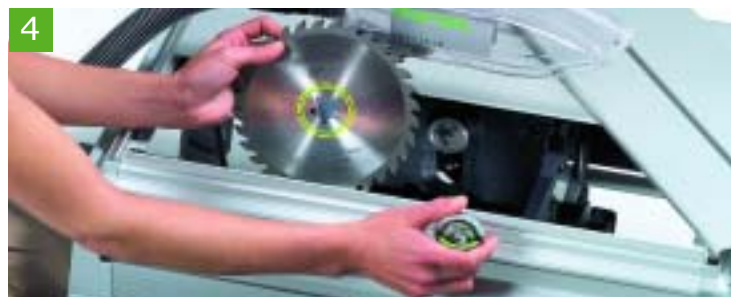
Het zaagblad kan eenvoudig van de opname worden verwijderd en gemakkelijk door een ander worden vervangen.
