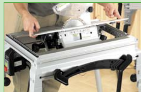
Compact Module Systeem CMS: het veelzijdige modulesysteem voor afkort- en lengtezaagsnedes, aan te vullen door andere modules, zoals frees, bandschuurmachine, etc.
