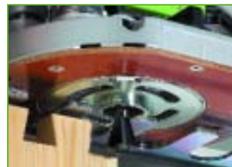
Eenvoudig te bevestigen: wisseling zonder gereedschap tussen loopzool en kopieerring (ook verkrijgbaar voor het verbindingssysteem VS 600).
