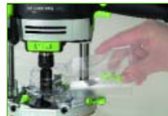
De afzuigkap kan ook worden gebruikt wanneer er een frees gemonteerd is.
