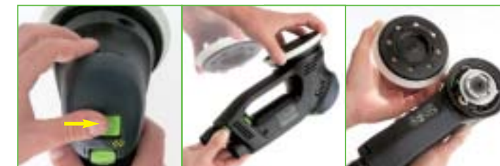
De schakelaar op de ROTEX®- De spilstop indrukken en de Nieuwe schijven eenvoudig gebogen baan zetten. schijf tegen de klok in draaien. opzetten en vastdraaien.
