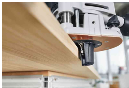
Spaanhanger, ideaal bij kantbewerking, vangt 90% van het op
