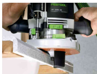
Zool-verbreding voor een goede geleiding bij de randen van het werkstuk
